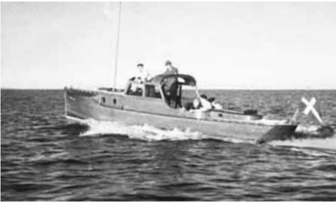
Motorbåtskryssaren "ASTRID", byggd 1936 för Dir. Pelle Hägglund Örns- köldsvik. Ömt vårdad och i originalskick redas "ASTRID" idag av sonen PG Hägglund. Något så ovanligt som en V-bottnad Petterssonbåt. Hade ursprungligen en Penta Hesselman på 40 hk, senare en 8 cyl Chrysler och numera en 96 hk Ford diesel. Foto från P.G. Hägglund.
