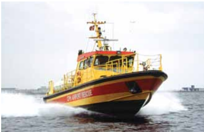
NB 459, ”AIRPORT RESCUE”. Skrovet är baserat på stridsbåten men modifierat utan bogramp och dimensionerat och byggd till Lloyd’s Registers ”Special Service Craft Rules” för Area G3, dvs. upp till 150 NM från hamn och farter upp till 50 knop.
