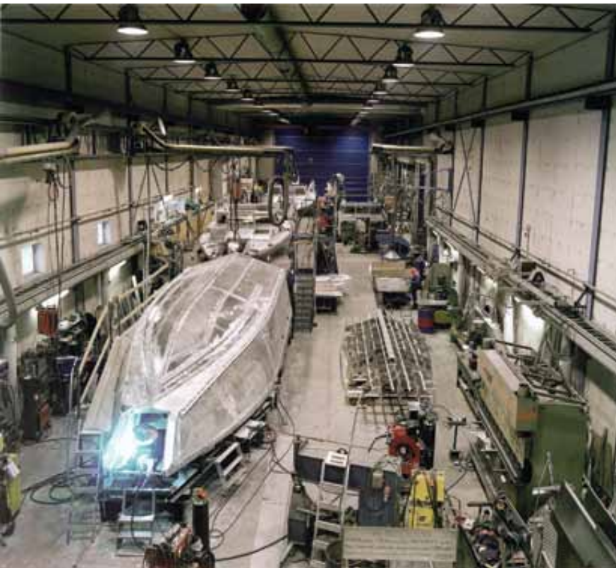
3 st stridsbåtsskrov under tillverkning i nybyggnadshallen, slutet av 1990 talet.
